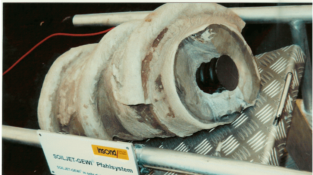
Figuur 6/11: Vrijgegraven verticaal verankeringselement met speciale schroefvorm.
