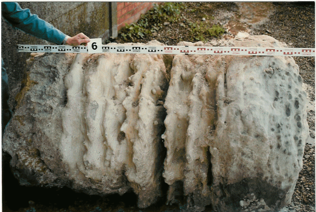
Figuur 7/3: Proefpaal uitgevoerd te Dessel met bi-jet waarbij de retourstroming geblokkeerd werd (Rapport KU Leuven).
