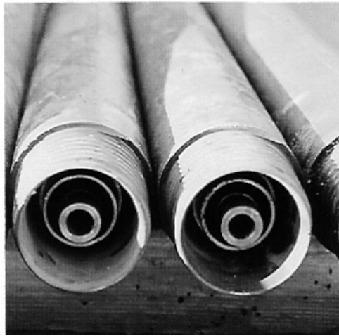
Figuur 2/6a: groutstangen Voor tri-jet
